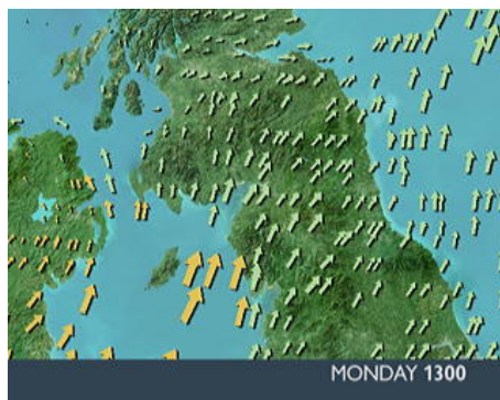
Εικ. 7-6: Μετεωρολογικός χάρτης, ενδεικτικός των ταχυτήτων επιφανειακών ανέμων σε δεδομένη περιοχή και χρονική στιγμή. Στη Ρευστομηχανική οι ολοκληρωτικές καμπύλες ενός τέτοιου πεδίου ταχυτήτων καλούνται γραμμές ροής.
