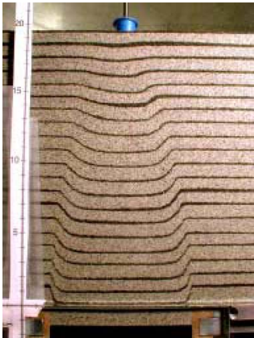
Εικόνα 2-14α: Πυκνή άμμος – Δοκίμιο 5
