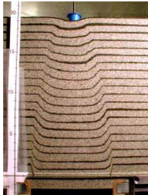
Εικόνα 2-14β: Πυκνή άμμος – Δοκίμιο 6
